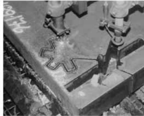
Bild 8. Ausschneiden der Knoten aus einem 180 mm dicken Stahlblech mit Autogenbrennschneider Fig. 8. Cutting of nodes out of steel plate 180 mm with autogenous cutting
